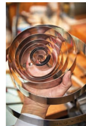
Fjäders driver urverket. Mycket klimategget, går helt utan el och kan fungera i hundratals år.
